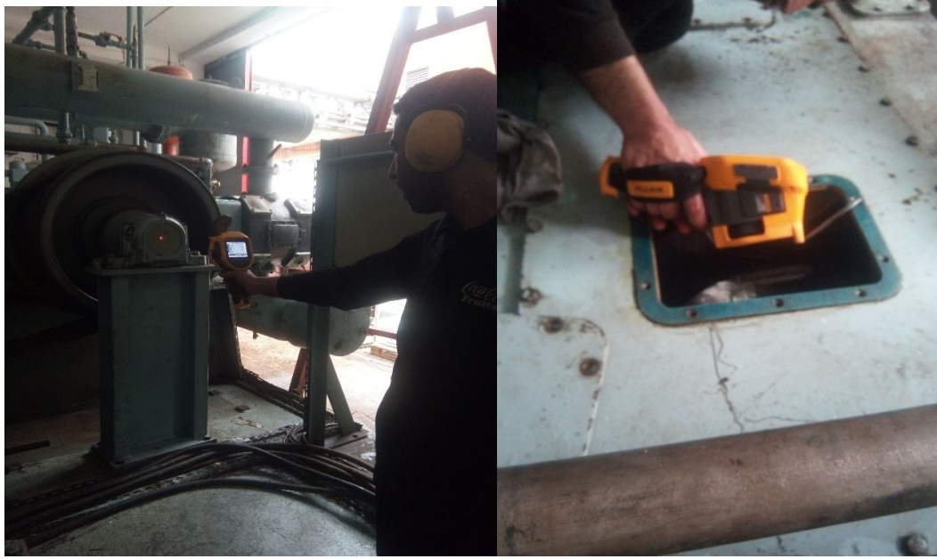
Fig. III.17. Contrôle de température avec une caméra infra-rouge
