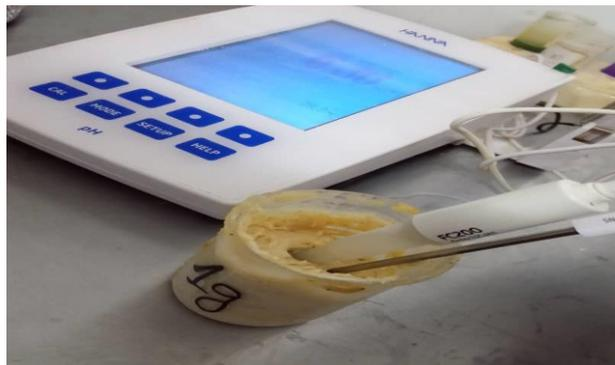
Fig. n°10: Mesure de pH par pH-mètre.
