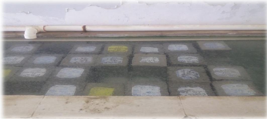
Figure -29- conservation des éprouvettes.
