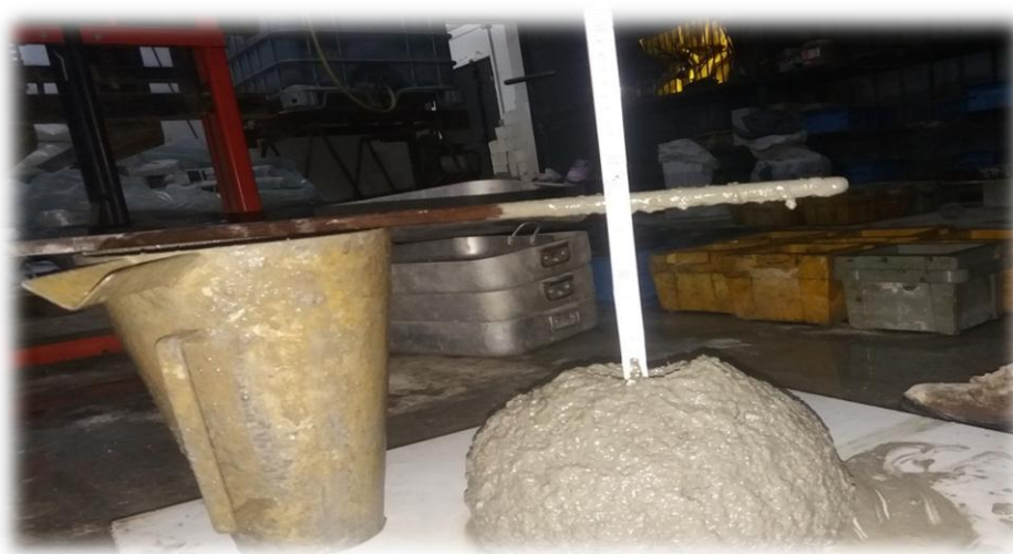
Figure -33- affaissement au cône D'ABRAMS.
