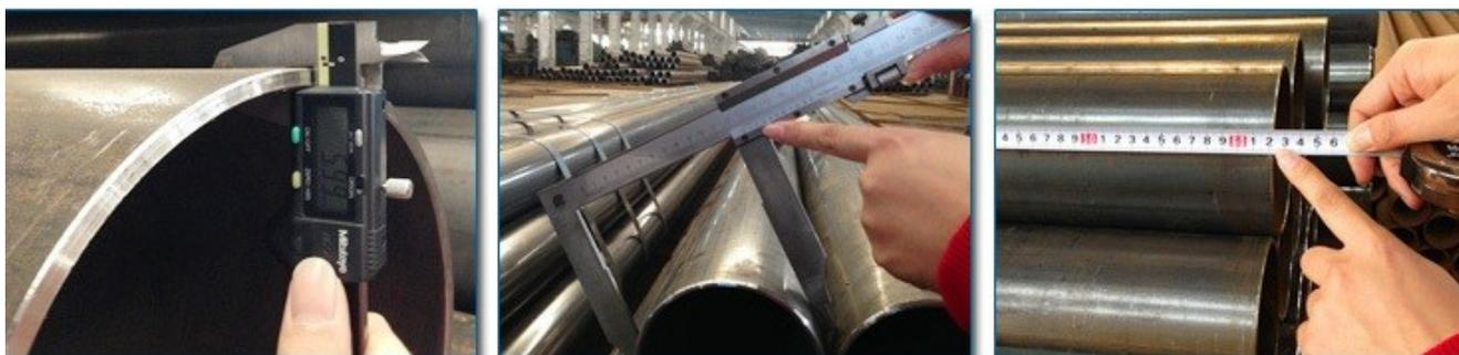
**Figure I.10 : Contrôle dimensionnel d'un pipe: mesure d'épaisseur, de diamètre et de longueur.**
