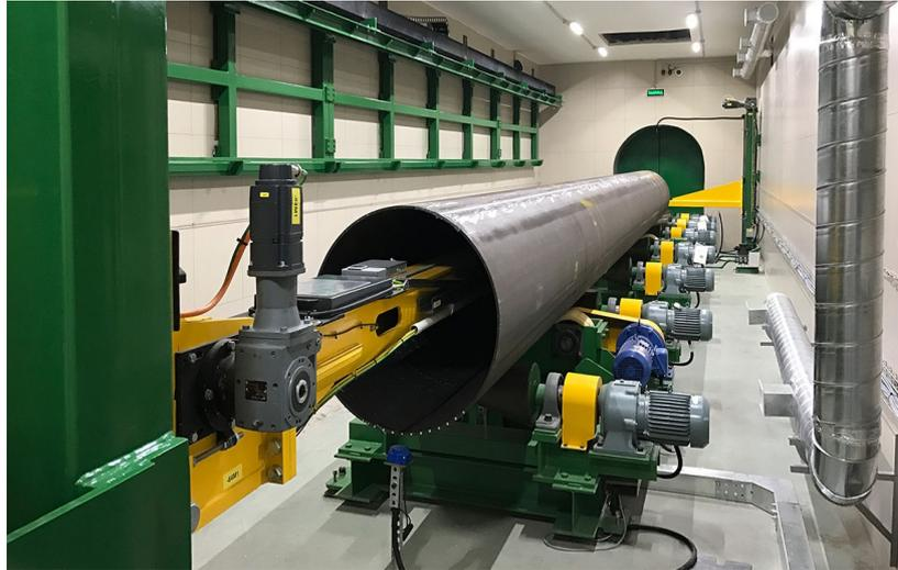
**Figure I.11: Contrôle par radiographie de pipe.**
