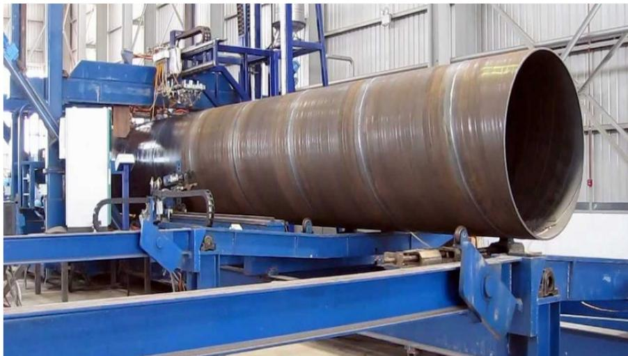
**Figure I.4 : Pipe après soudage en spirale.**
