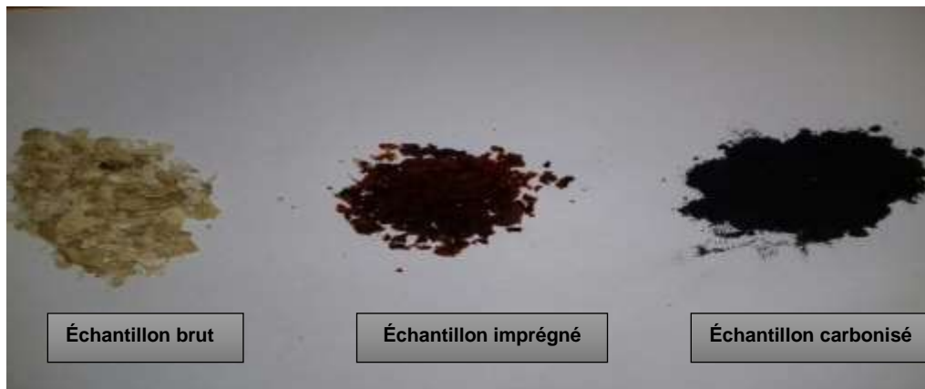
Figure IV-3 : Etapes de préparation d'un charbon actif
