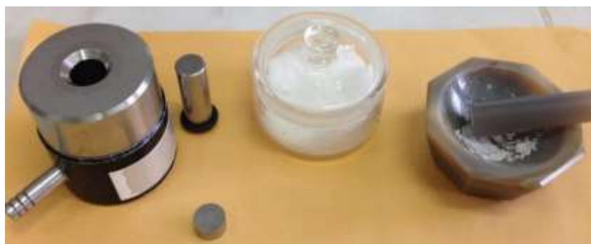
Figure IV-4 : La préparation des pastilles
