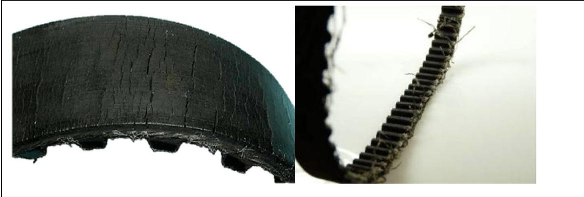
Figure I.12 Défauts de courroies. [21]
