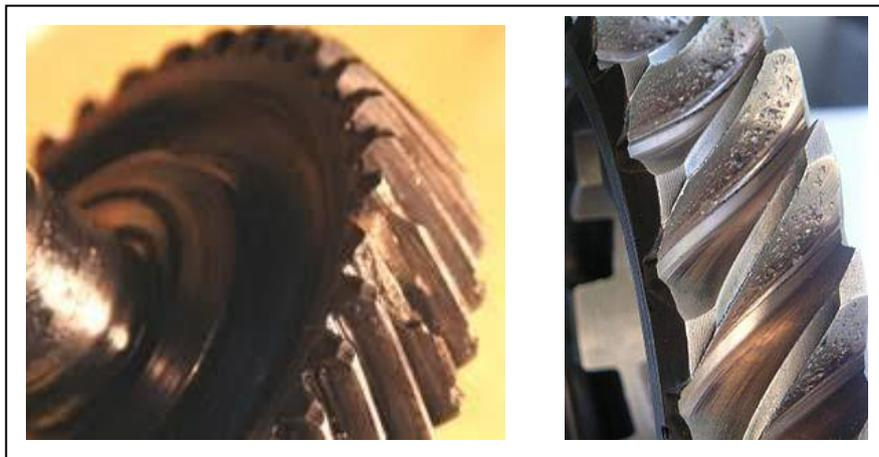
Figure I.11 Défauts d'engrenages. [17]
