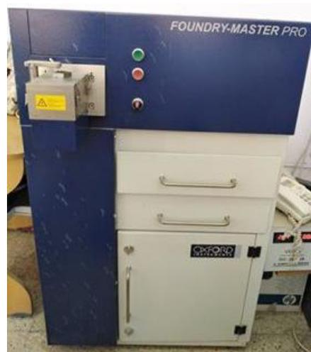
Figure II.18 :spectromètre de type FOUNDRY-MASTER PRO.
