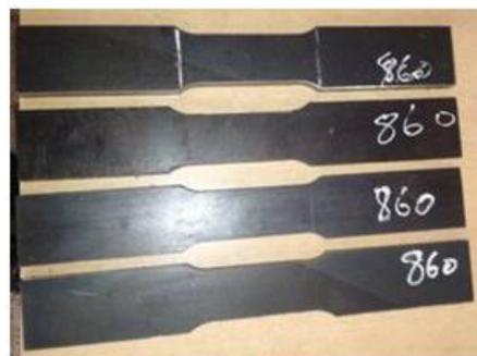
Figure III.10 : Eprouvette pour l'essai de traction.
