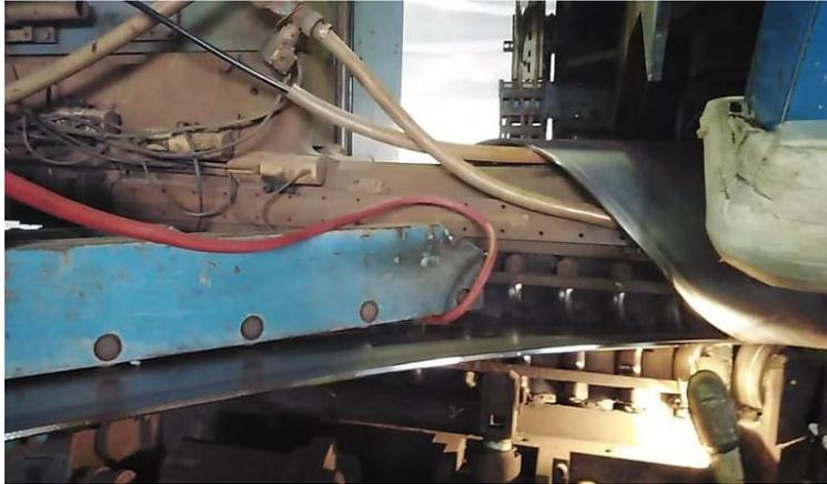
Figure I.4: Cage de formage du tube.
