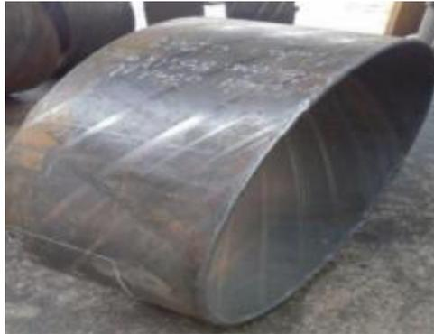
Figure III.1 : Une virole découpée à partir d'un tube.
