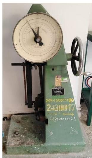
Figure II.16 : Mouton pendule testwell.
