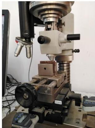
Figure II.14 :Microduromètre.
