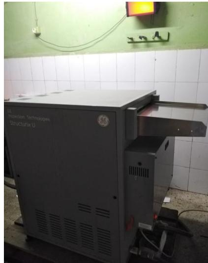
Figure II.6 : Développeuse de film radiographique (structurix U).
