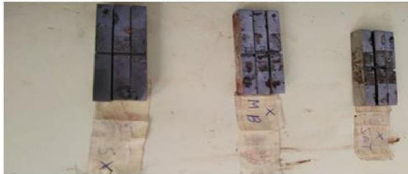
Figure III.5 : Epreuve pour l'essai de résilience en V.
