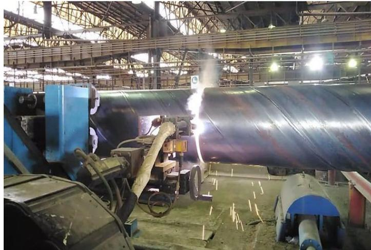
Figure I.7: Oxycoupage des tubes.
