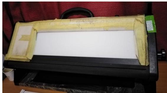
Figure II.7: Négatoscope (pour observation des défauts).
