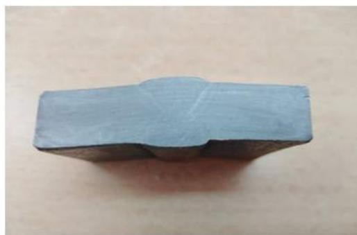
Figure III.7 : Eprouvette pour l'essai de dureté.
