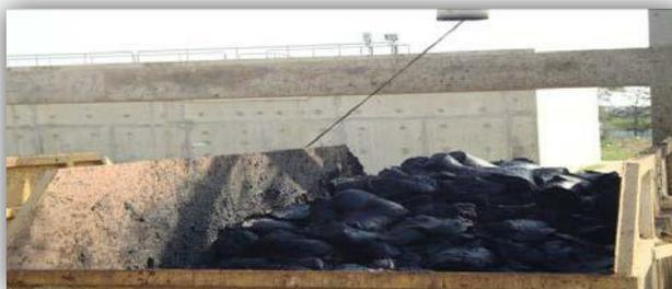
**Figure N°III.18 :** Benne à évacuation des boues déshydratées.
