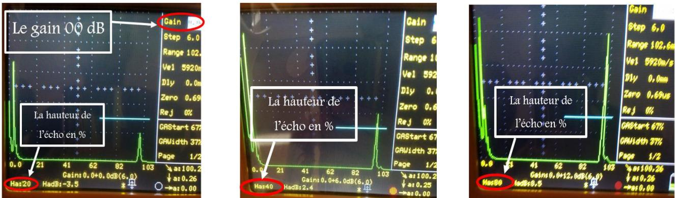
Figure IV.17: Vérification du point d'émergence
