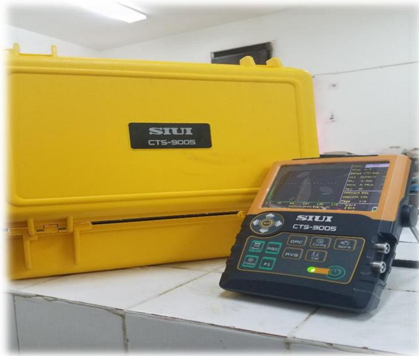
Figure IV.11 : Appareil détecteur des défauts par ultrasons SIUI CTS-9005.
