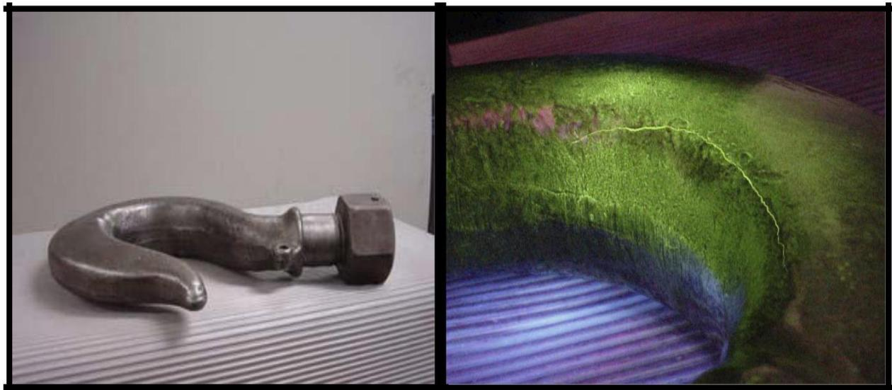
**Figure III.6 : Fissuration en service d'un crochet.**
