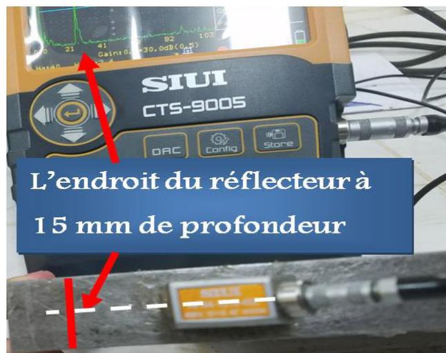
Figure IV.19: Vérification de l'angle de Bigle
