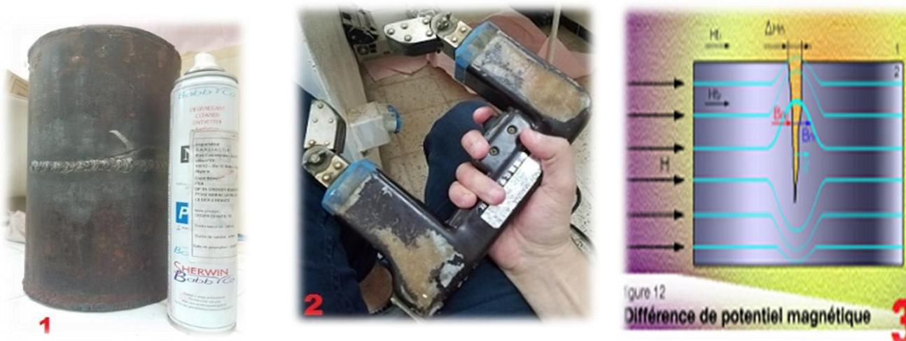
Figure IV.7: Le matériel nécessaire pour le contrôle par magnétoscopie.
