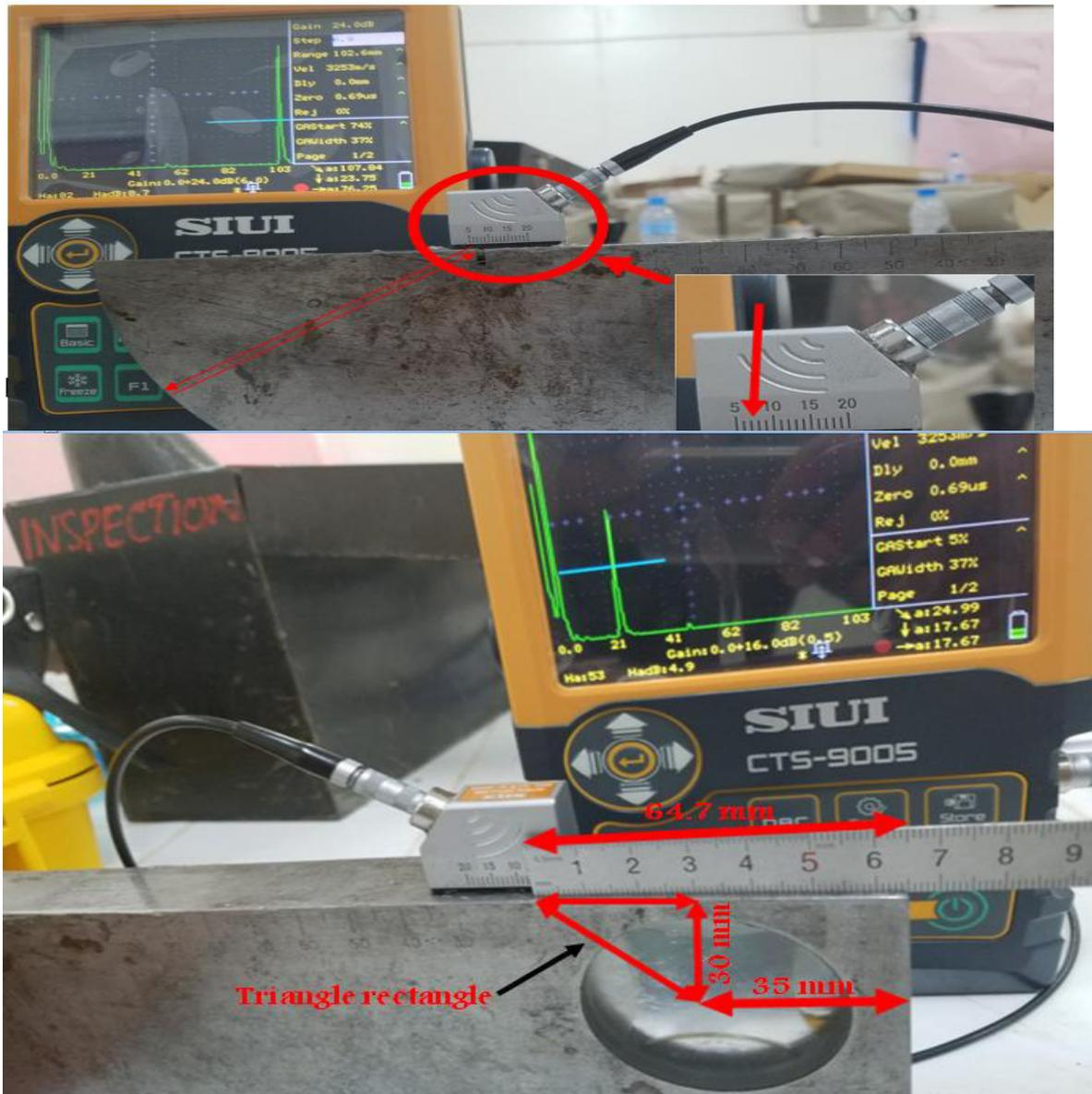
**Figure IV.18: L'angle de réfraction**
