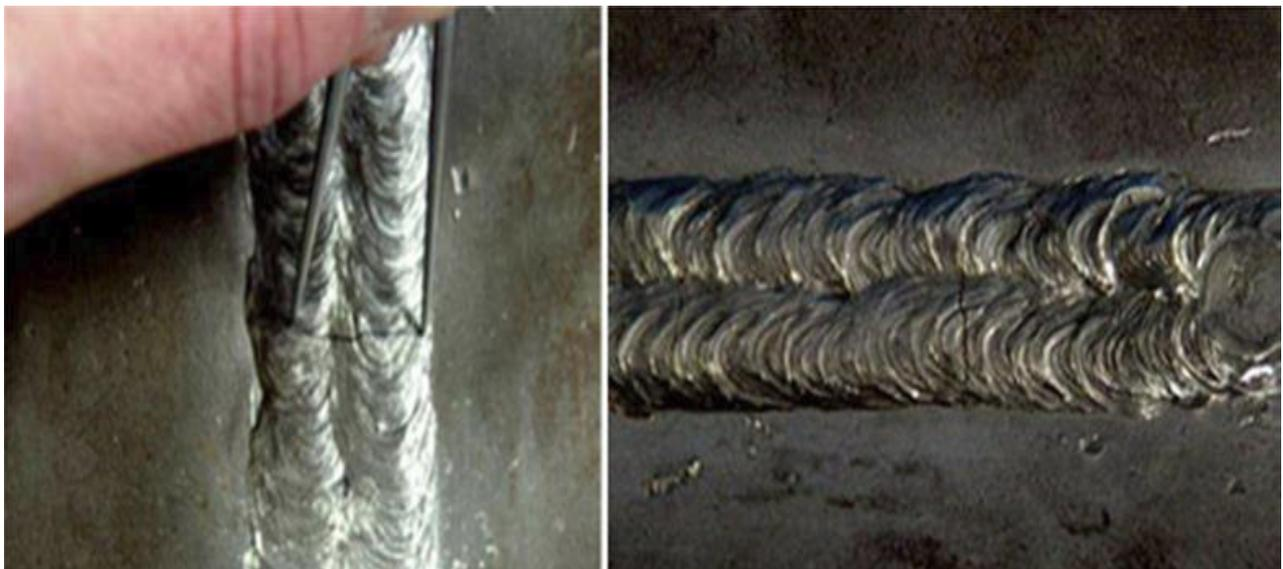
Figure II.2 : La fissure transversale.
