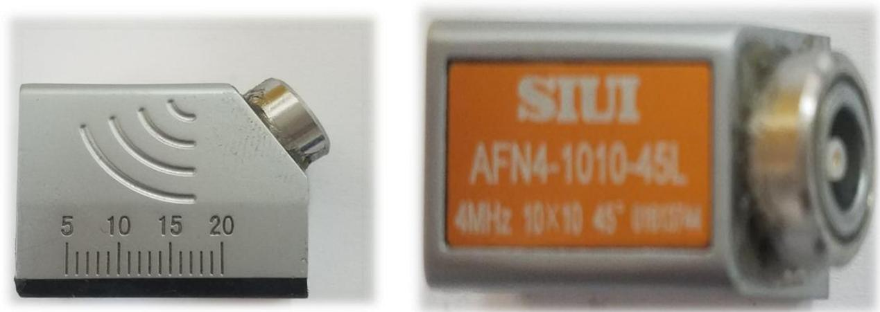
Figure IV.13 : Palpeur a angle SIUI AFN4-1010-45L (4MHZ) 45°
