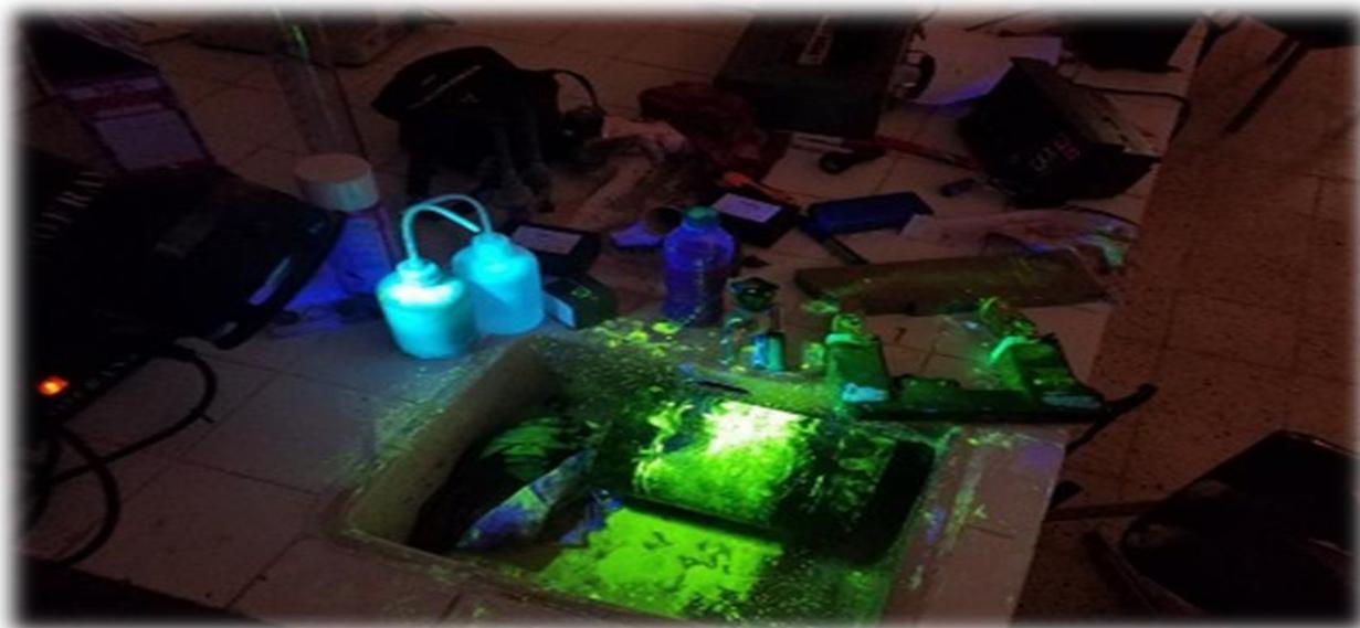
Figure IV.6 : Contrôle par magnétoscopie.
