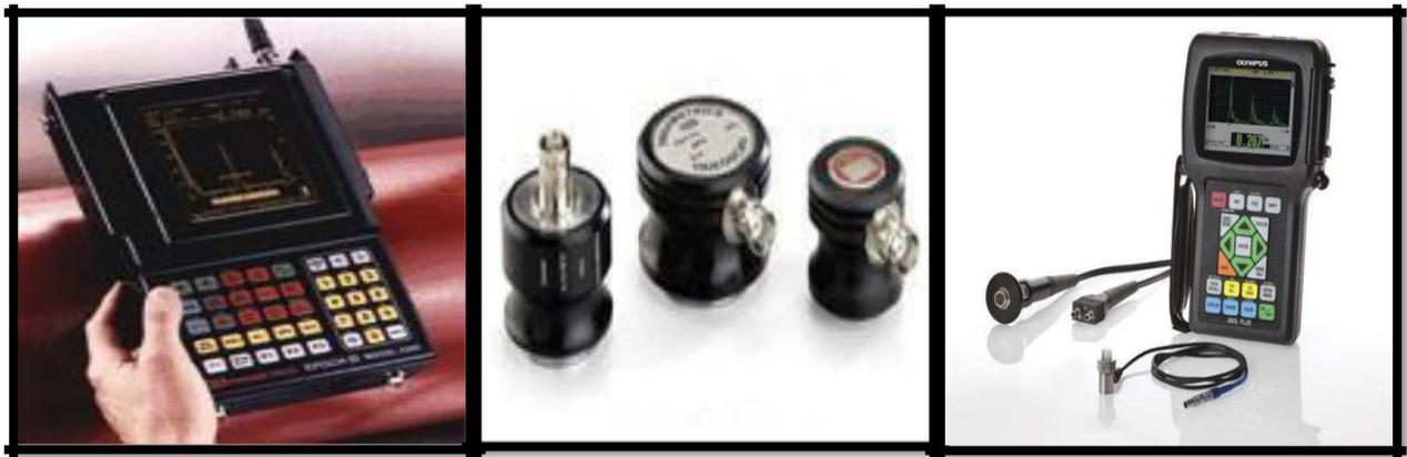
Figure III.9 : Appareil de contrôle par US Traducteurs Mesureur d'épaisseur
