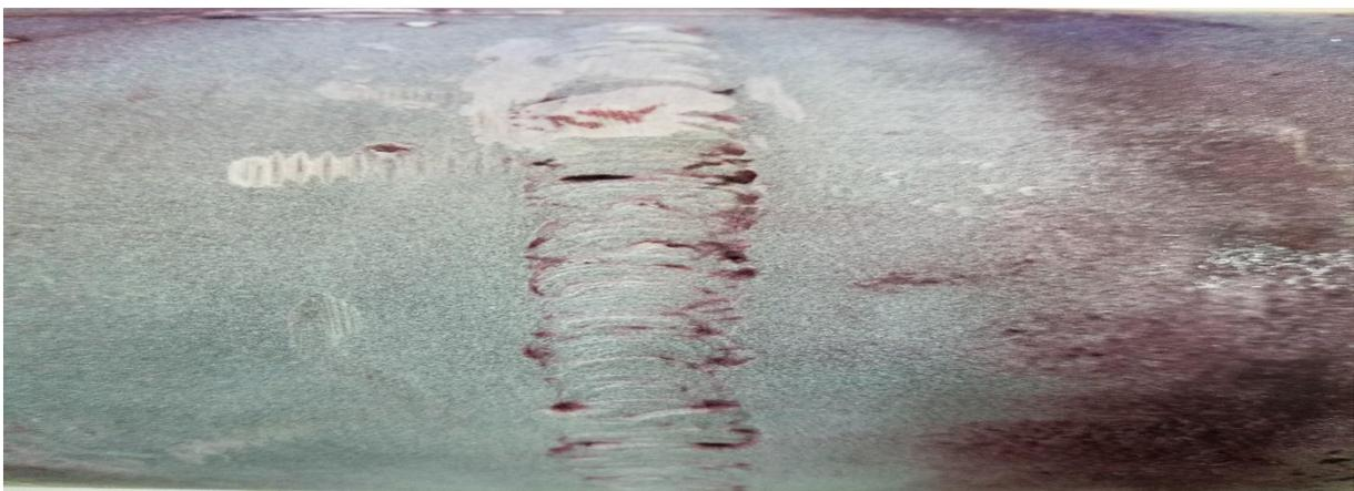
**Figure IV.5 : Les défauts détectés dans la pièce après ressuage.**
