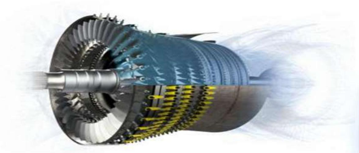
**Figure I.5:** Compresseur axial haute pression
