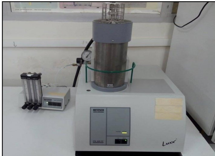
Figure N°IV.12. Equipement ATG, STA 409PC Luxx.
