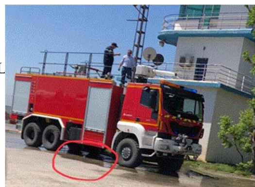
Figure II 3: Camion du SSLI près de la DOS en fuite d'eau.
