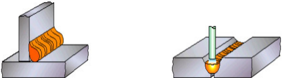
**Fig. 3.21 : manque de pénétration dans la soudure**
