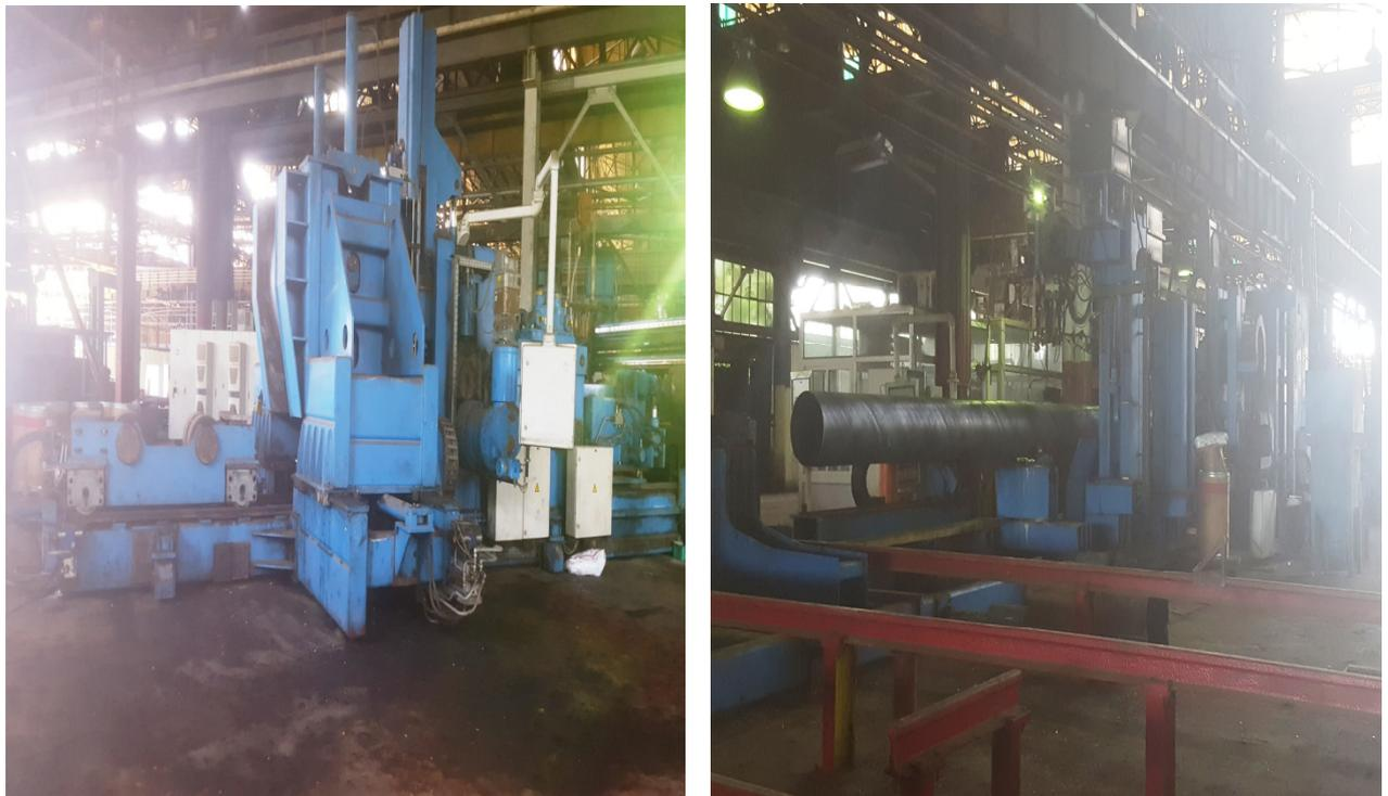
Fig. 2.1: machine à soudage spirale
