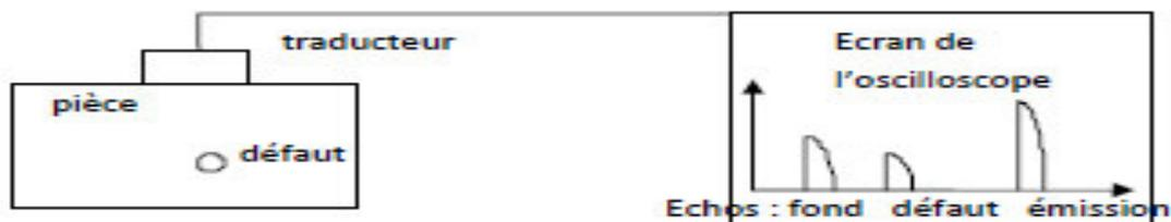
Fig. 4.22 : principe de mesure
