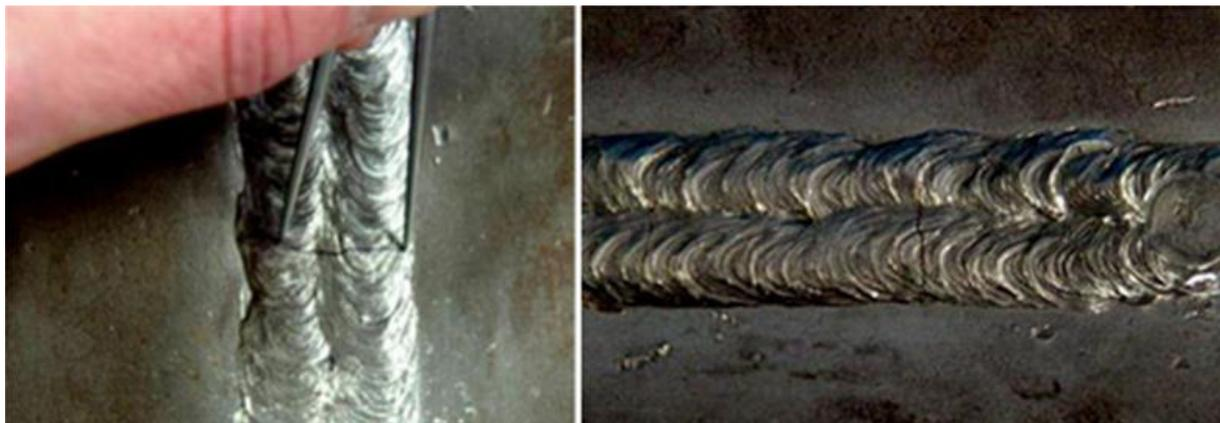
**Fig. 3.2 : fissure transversale**
