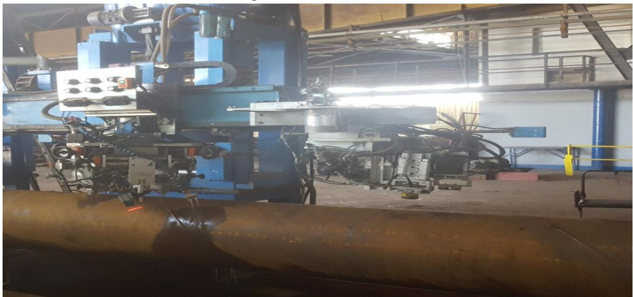
**Fig 4.23. Balayage des palpeurs droits sur le métal de base.**
