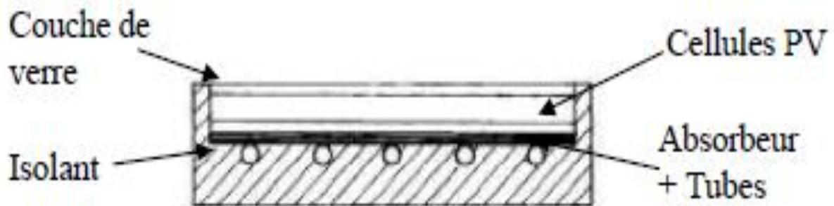
**Figure II.15:** Section du capteur solaire hybride à eau étudié [121].
