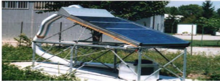
**Figure II.2.** Système PVT avec circulation d'air [88].
