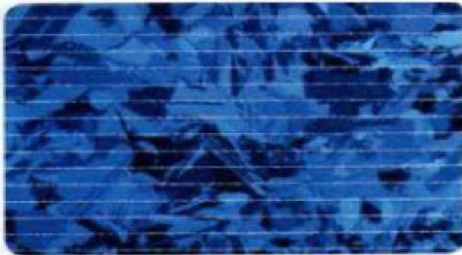
**Figure I.19** : Photos de cellules multicristallines.
