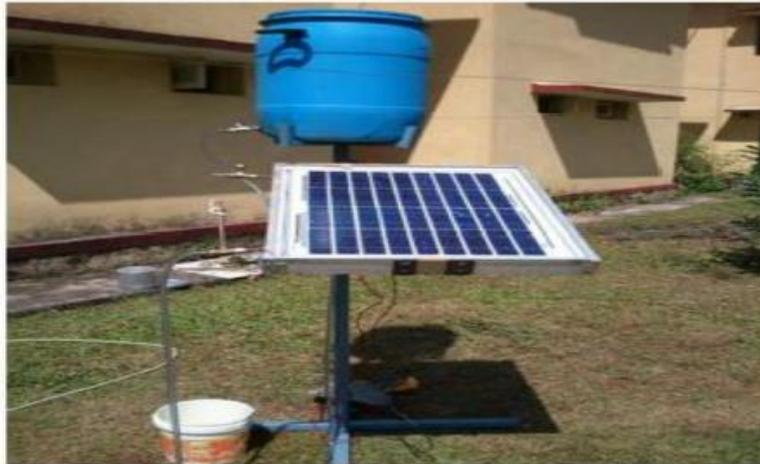
**Figure II.18 :** Système PVT et de la plate-forme d'essai extérieure [126].
