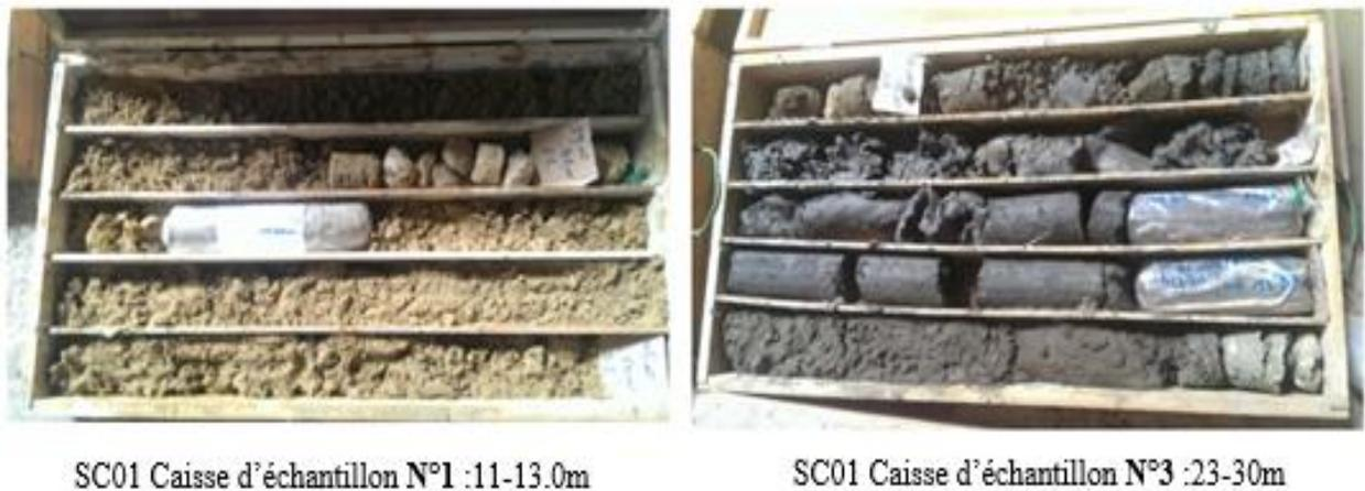
Figure II.9 : quelques échantillons extraits par carottage.
