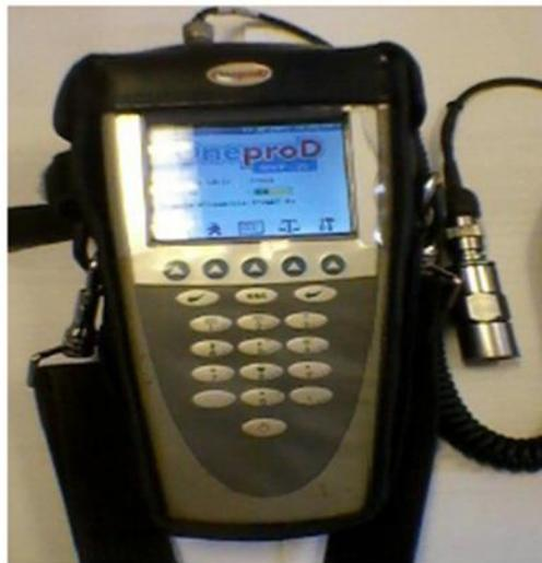
Figure. IV. 2 : Analyseur- MVP-200
