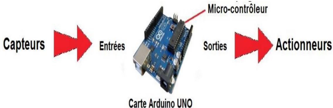
**Figure II.4 :** Architecture de la carte arduino UNO [4]
