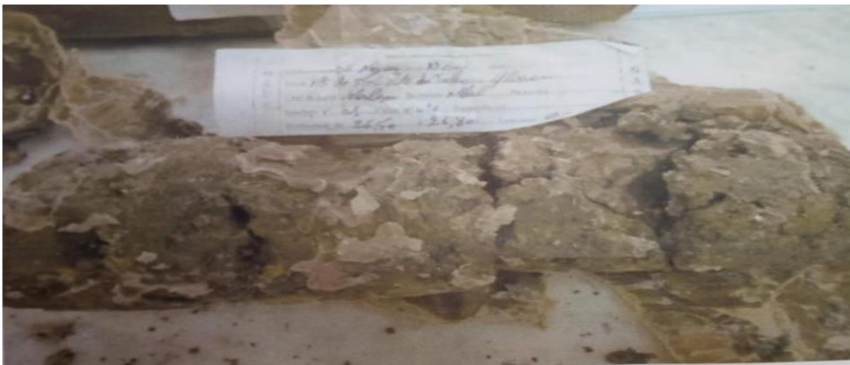
IV- Figure 9 : Photo montrant l'échantillon friable et induré du sondage carotté SC 01 (PF : 26.50 – 26.80m).
