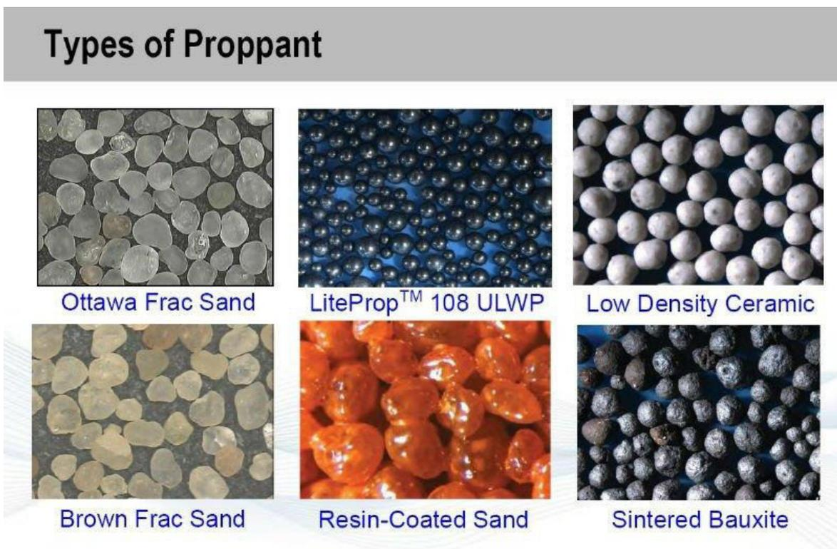
Figure I. 12: Matériaux de base pour les proppants
