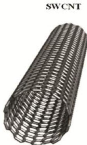
*Figure II. 3 Représentation graphique d'un nanotube de carbone monoparois (SWCNT)*
