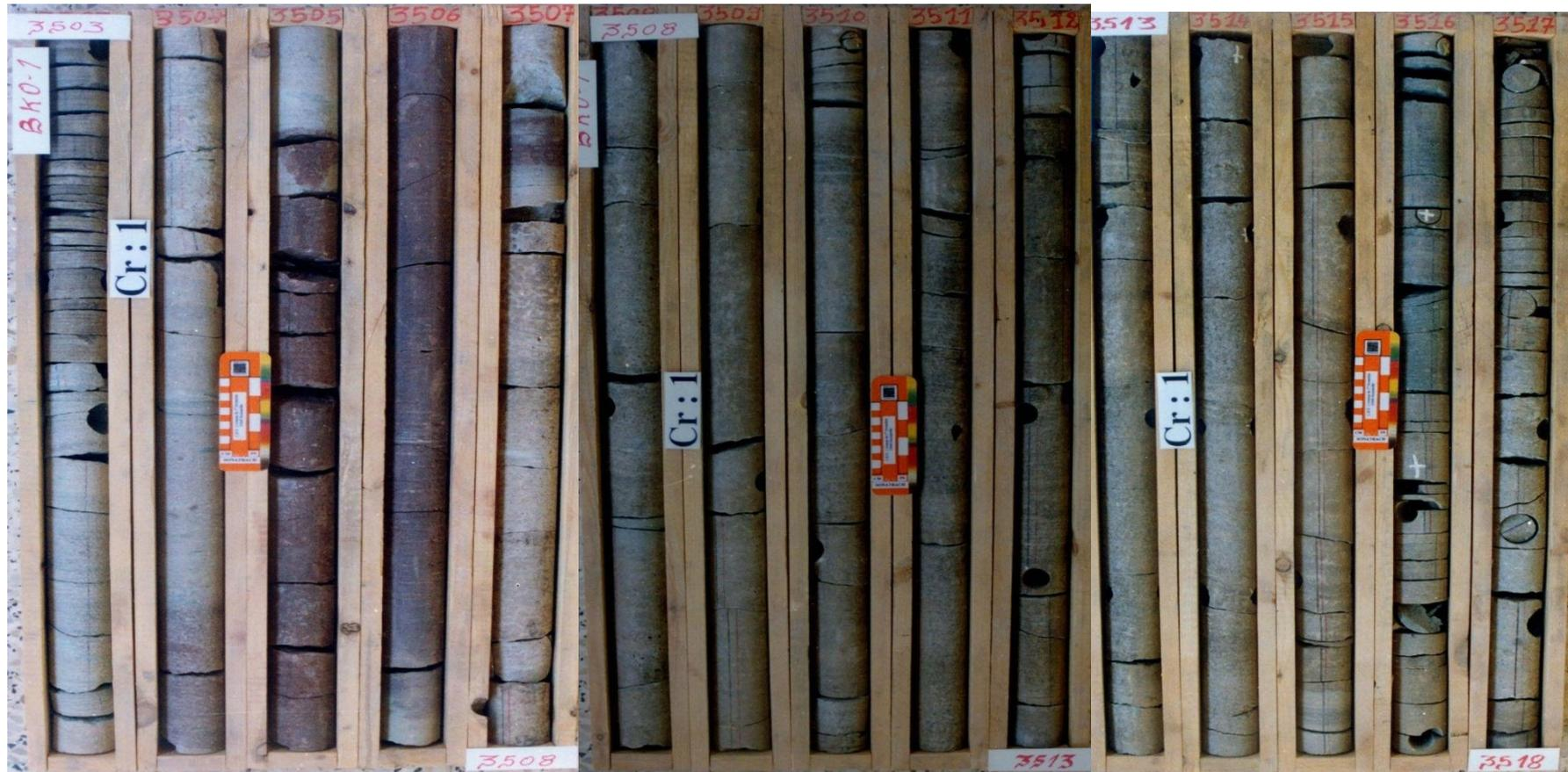
**Figure III.A : carotte 01 a l'Intervalle 3503 à 3517.5 m du Trias T1**
