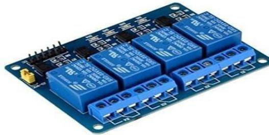
**Figure II.9 :** Module de relais à 4 canaux.
