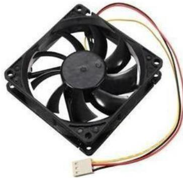
**Figure II.10 :** Ventilateur 5V.
