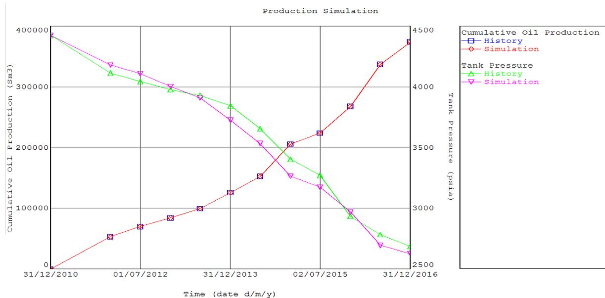
Figure IV.16, Validation du modèle (Matching)
