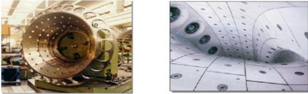
Figure. I. 3:Vue externe et interne de la chambre de combustion
