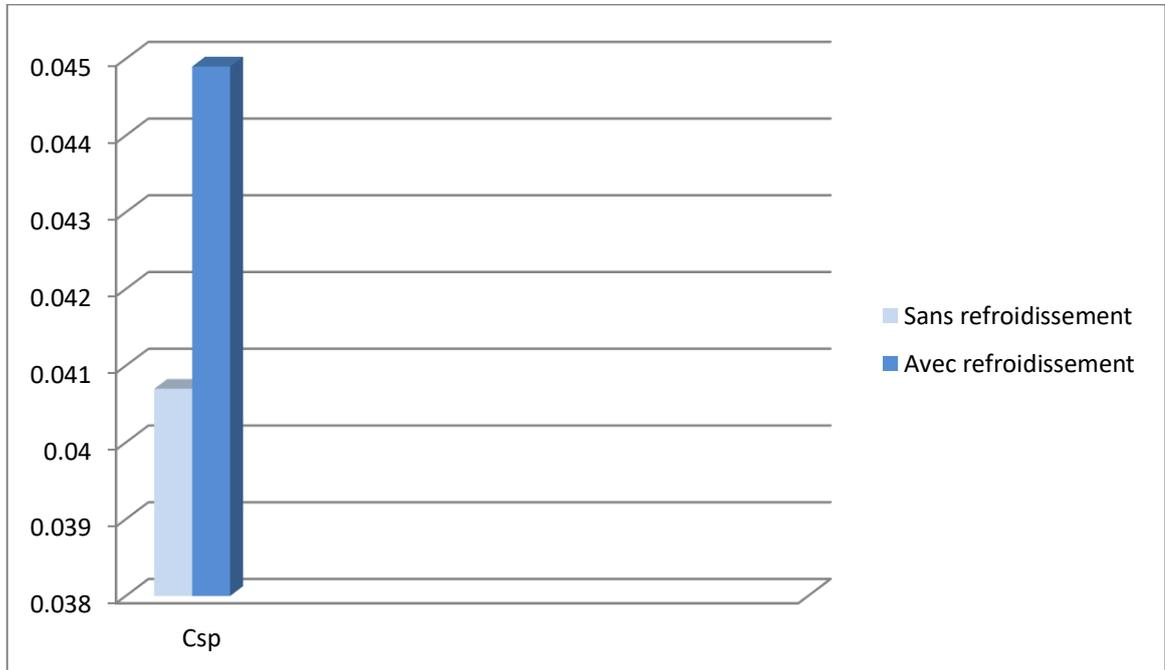
**Figure III. 7:** Comparaison de la consommation spécifique sans et avec refroidissement à  $Z=0$  et  $M=0$ .
