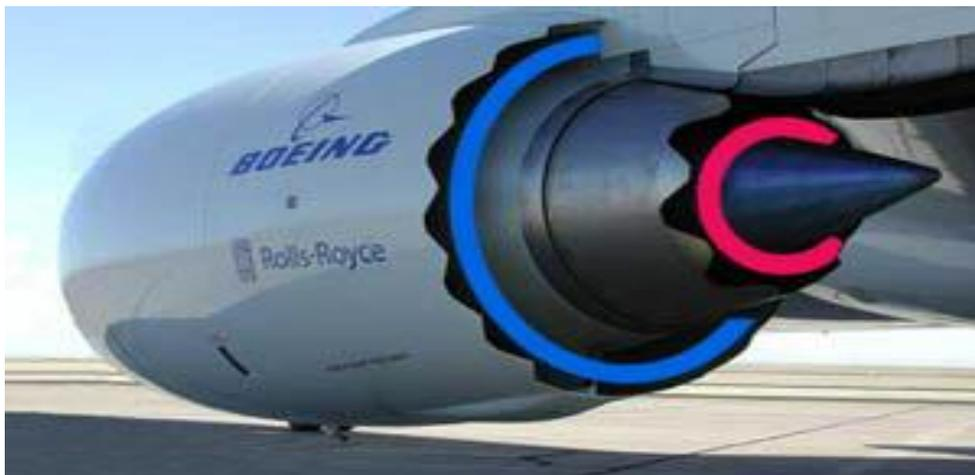
**Figure I. 7:** Tuyère de turboréacteur a double flux séparés.
