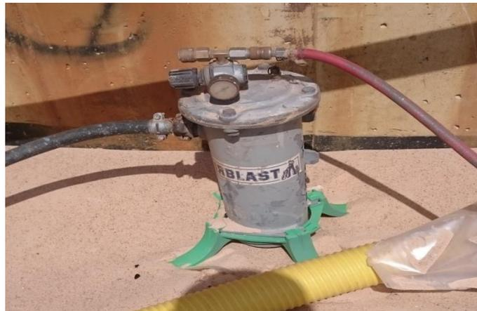
Figure IX. 5: Régulateur d'air.
