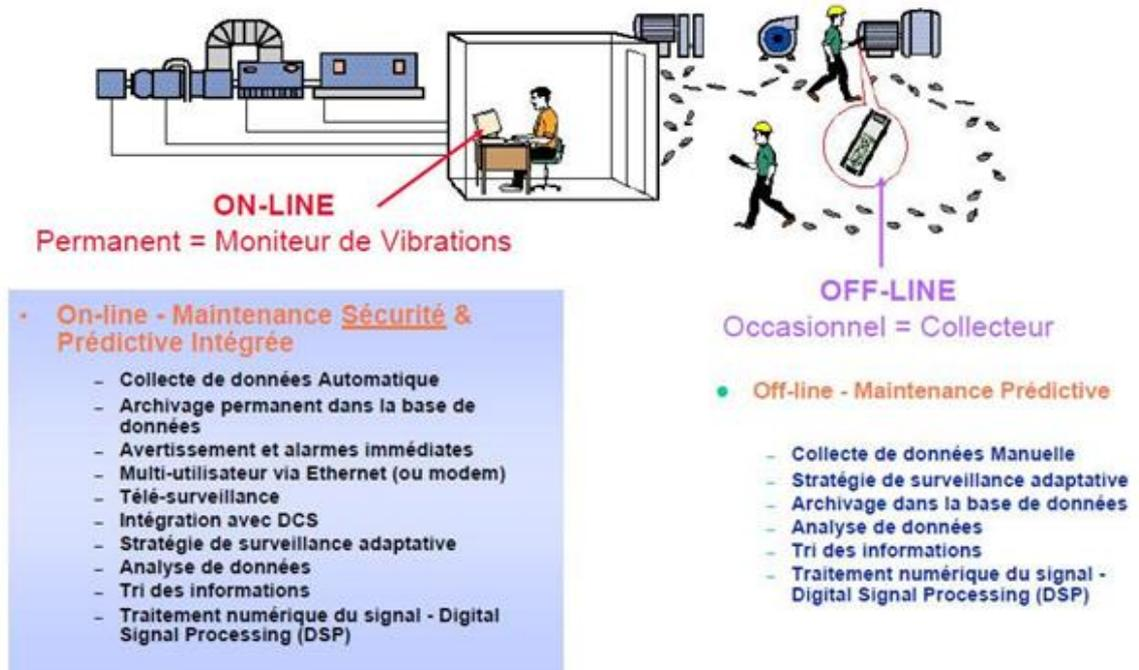
Fig. III.5 Les types de surveillance des machines [14]
