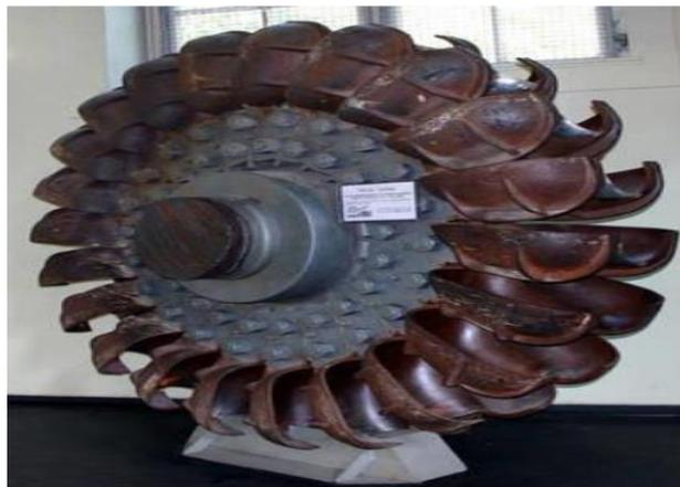
**Figure II.11** Roué d'une turbine Pelton
