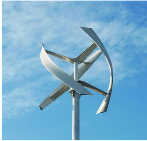
**Figure I : éolienne a axe verticale**
