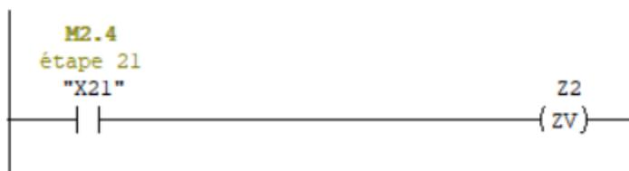
☐ Réseau 46 : Active la montée cuve rinçage
