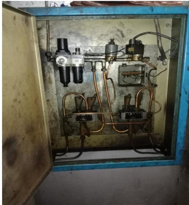
Figure I.12: Armoire pneumatique lavage rinçage
