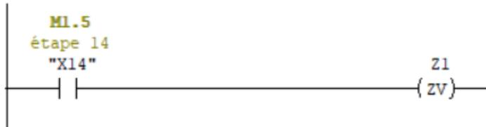
☐ Réseau 42 : Active la montée cuve lavage
