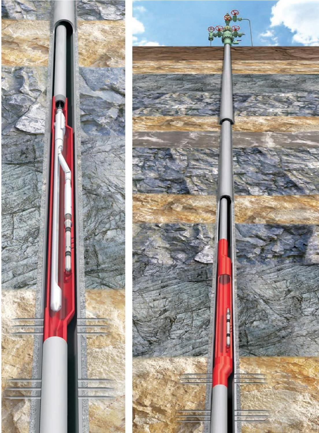
Figure 4.2 : Pose d'une vanne GL dans son siège à l'intérieur d'un mandrin par le « kickover tool ».
