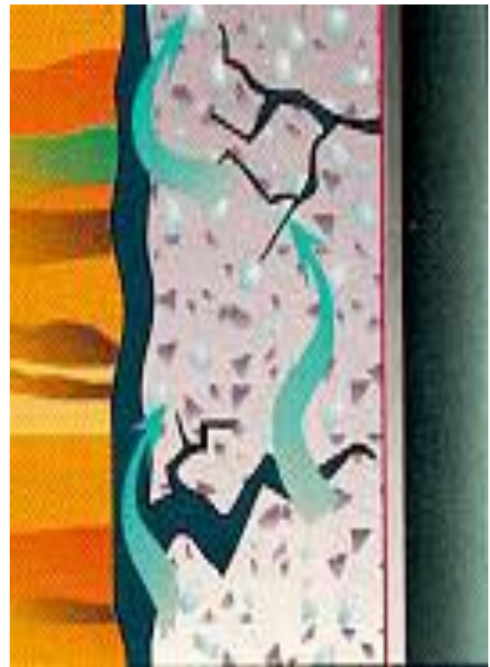
Figure 8: Intrusion de gaz à travers les fissures de la matrice après prise [18]
