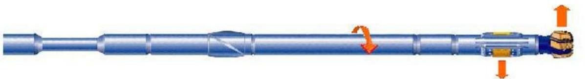
Figure 2.11 Push-The-Bit System
