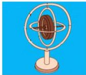
**Figure 2.3:** Gyroscope mécanique
