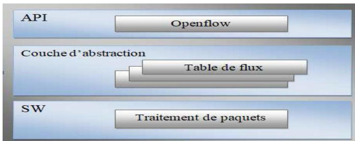
Figure 2.3 : Les composants d'un Switch open flow
