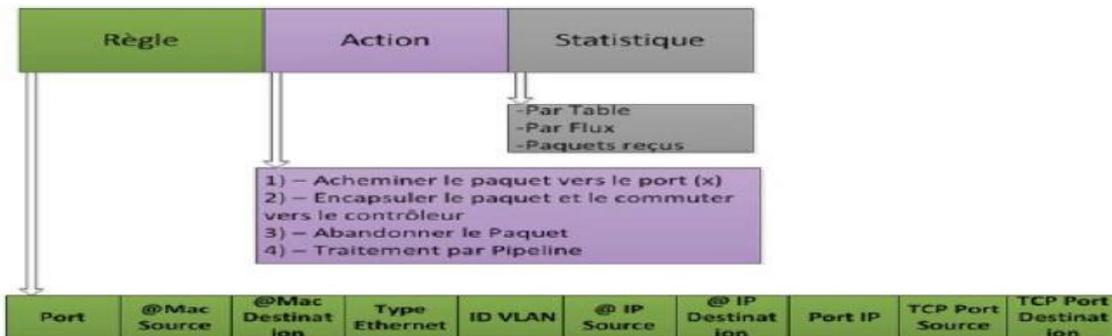
Figure 2.16: Les composants d'une table de flux
