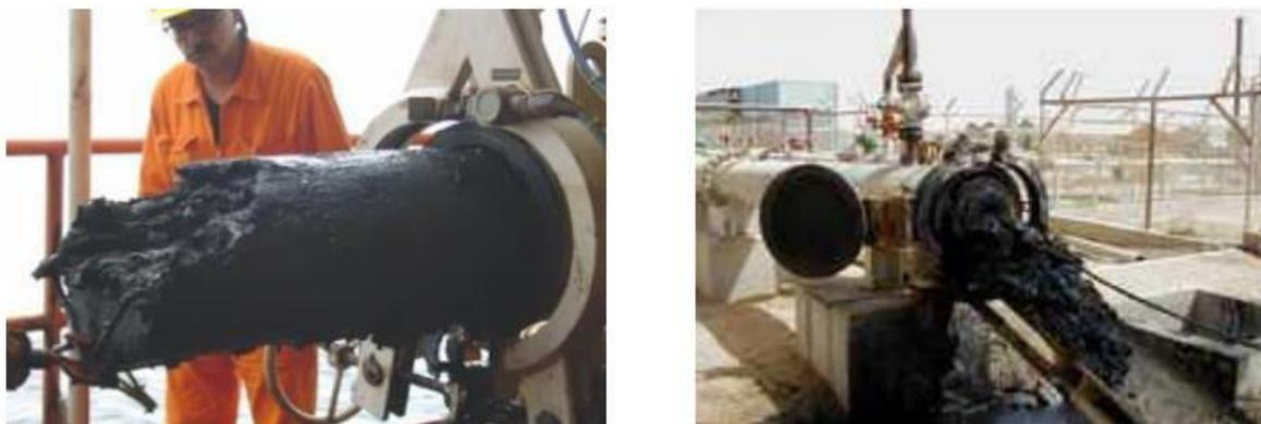
Figure II .24 : Dépôt asphaltène après une opération de raclage
