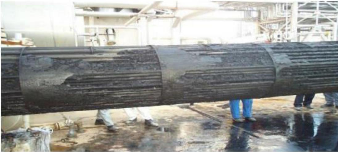
Figure II .25 : Dépôt d'asphaltène dans un échangeur de chaleur
