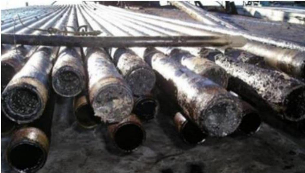
Figure II .23 : Dépôt d'asphaltène dans les tubings de production
