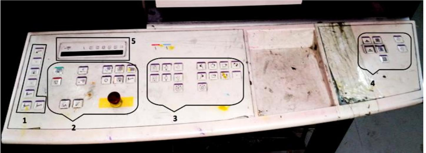
**Figure I.6.** Poste de commande margeur.
