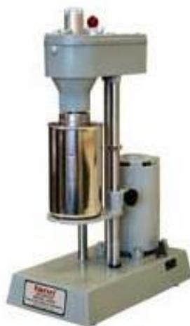
**Figure III.1 :** Viscosimètre FANN model 35 A
