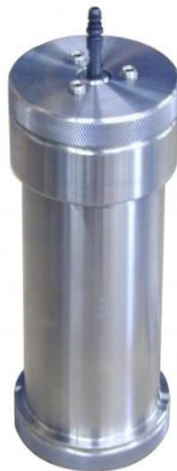
**Figure III.6 :** Cellule de Hot Rolling type OFITE
