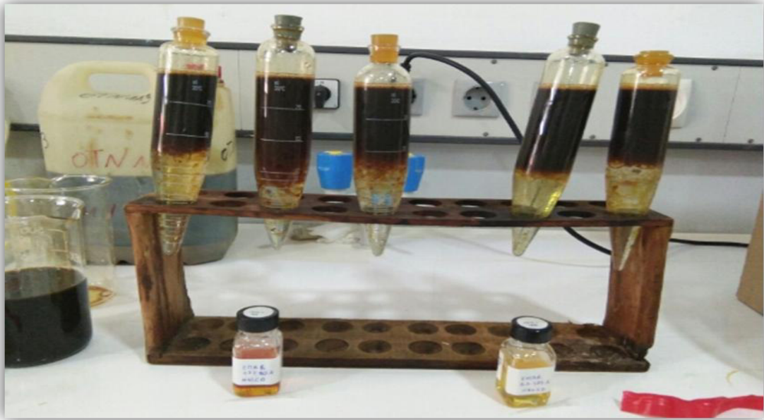
Figure 2.7: Les échantillons de brute avant l'ajout du d'émulsifiant.
