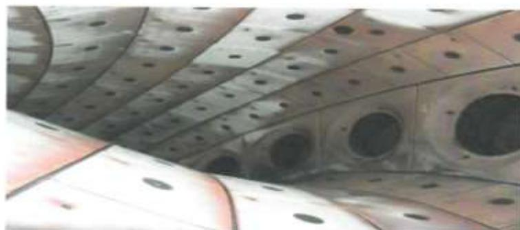
Figure I.5: Vue interne de la chambre de combustion
