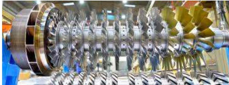
Figure I.4: Compresseur axial
