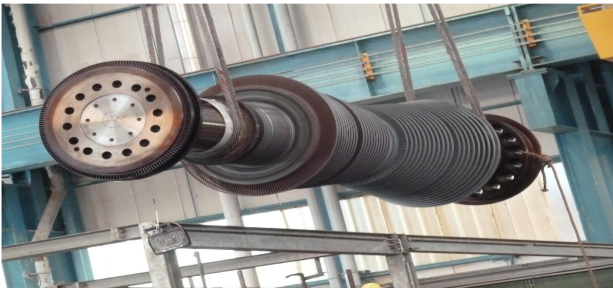
Figure I.5. Corps turbine moyenne pression (MP).
