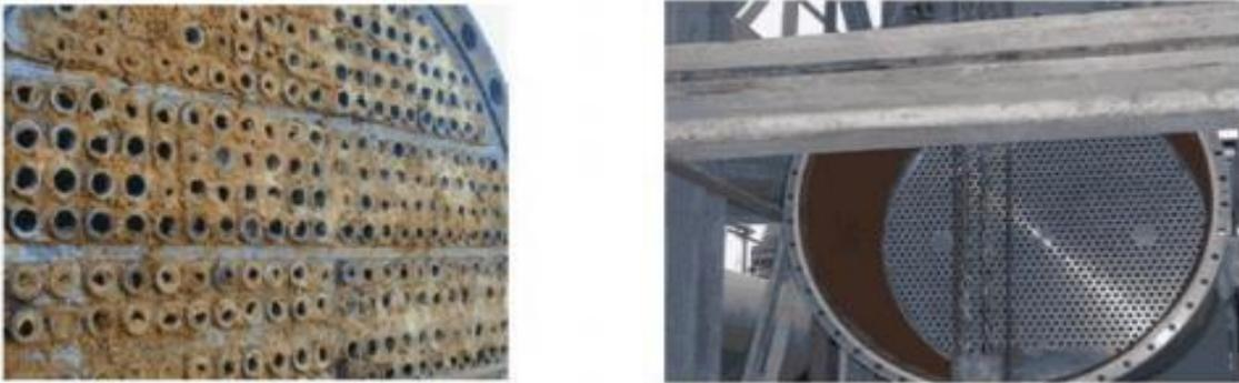
**Figure III.12** : échangeur propre (a droit) et échangeur sale (a gauche).
