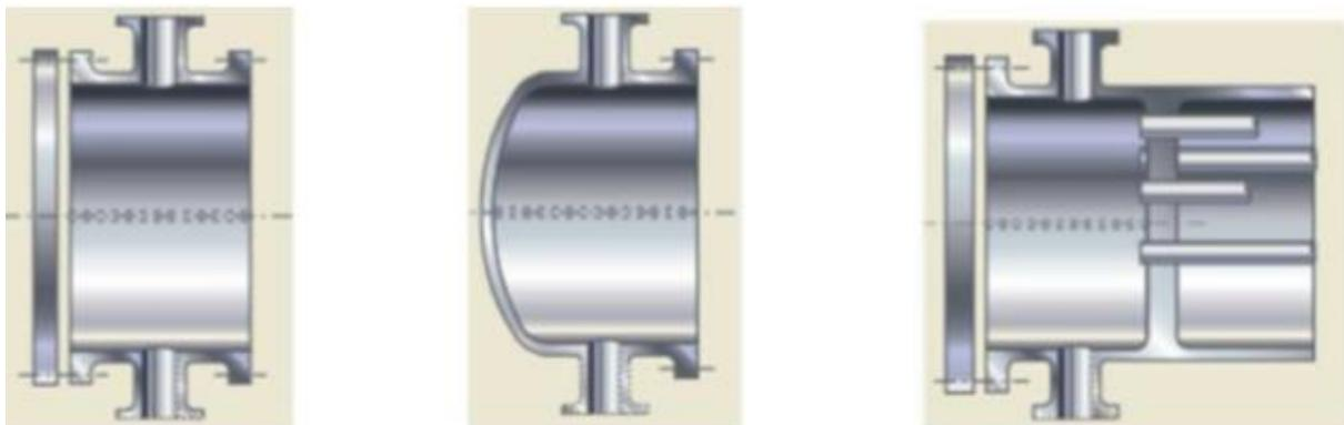
Figure III.7 : types des boîtes de distribution.
