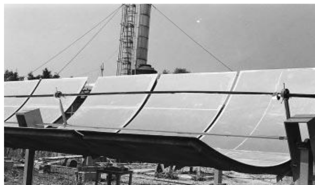
Figure I.1 : Vue de la flexion du tube absorbeur en acier inoxydable.
