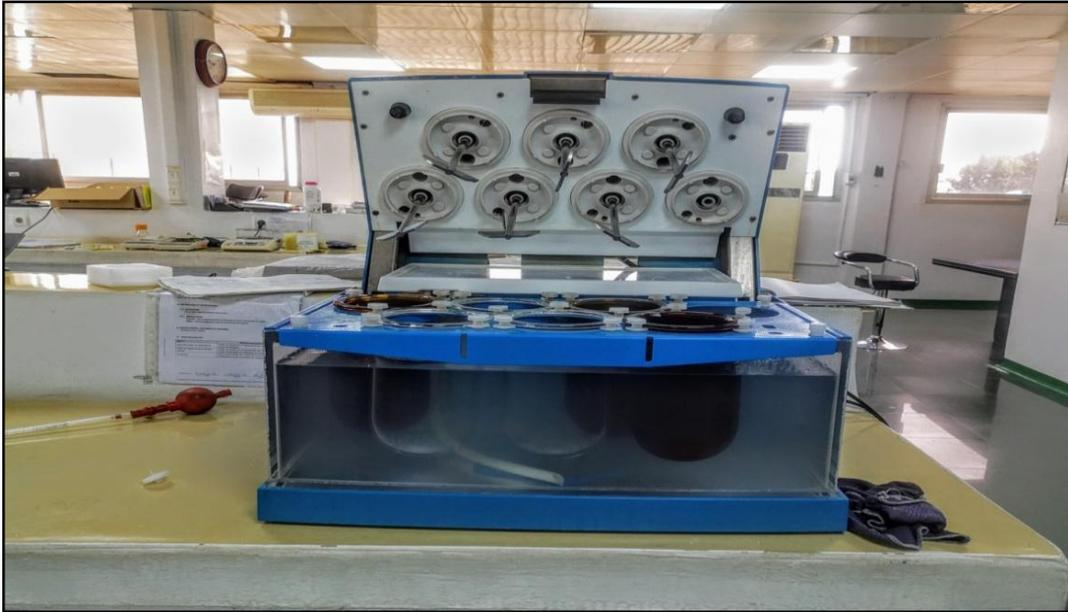
**Figure III-4 :** Appareil de Dissolutest SOTAX® (AT7 Smart)
