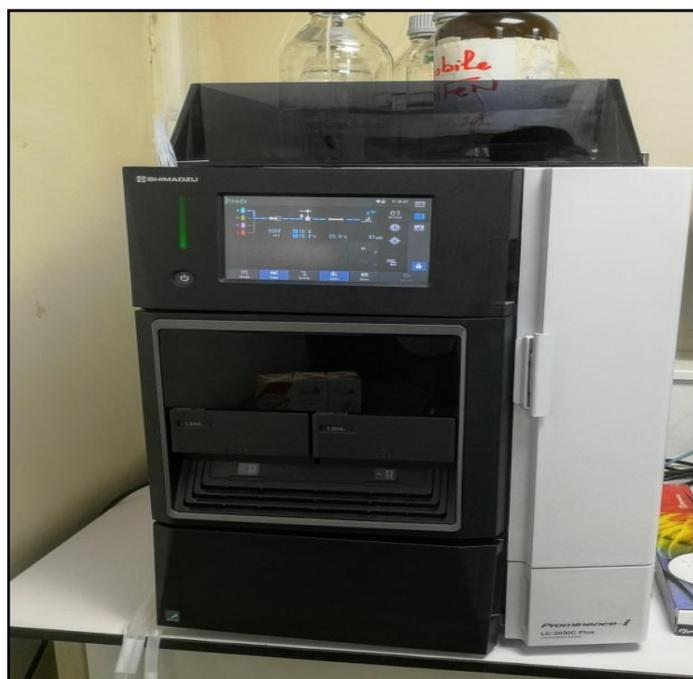
**Figure III-2** : Appareil d'HPLC SHIMADZU® (LC2030c plus)
