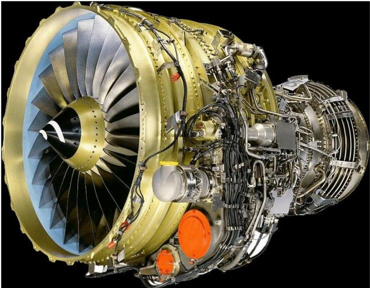
**Figure 14 : Turboréacteur CFM56-7B**
