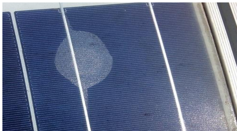
Figure II.13. Module photovoltaïque présentant une délamination. [29]
