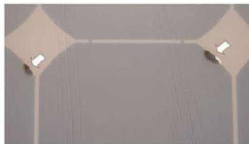
Figure II.16. Modules présentant des points chauds sur les bords des coins supérieurs. [47]
