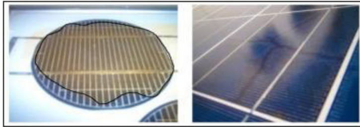
Figure II. 13 : Modules photovoltaïques avec des cellules décolorées.
