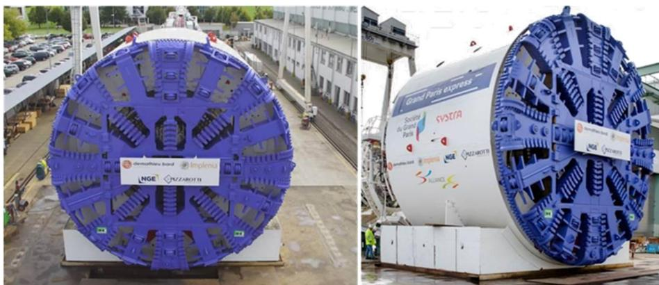
Fig. I11.17. Tête de coupe et bouclier d'un tunnelier, [21]
