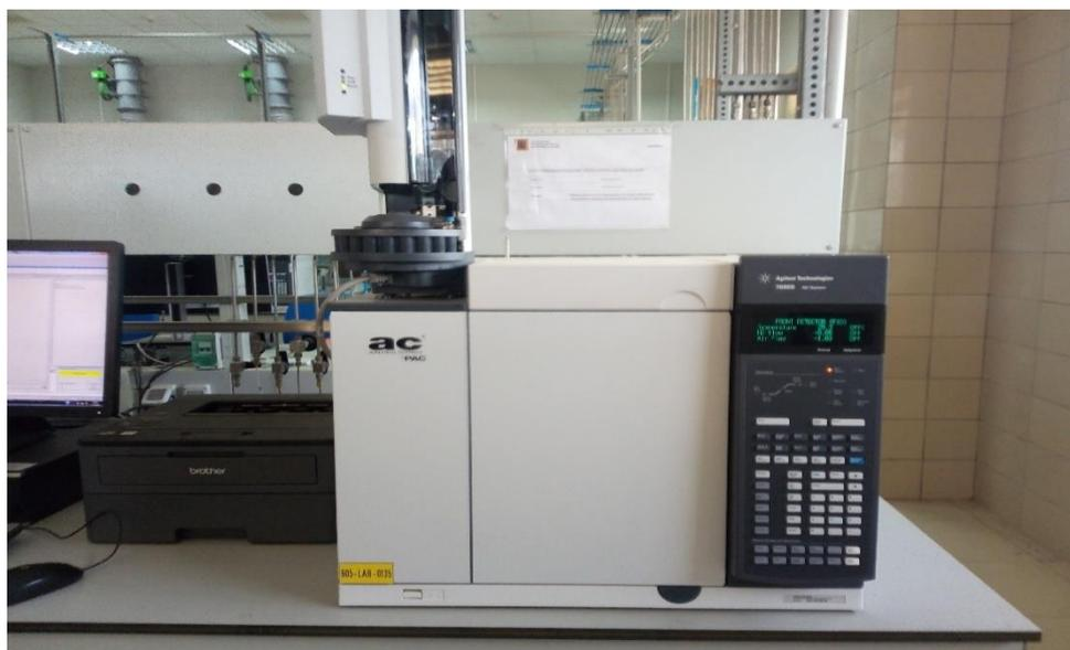
**Figure III.13 :** chromatographie en phase gazeuse.
