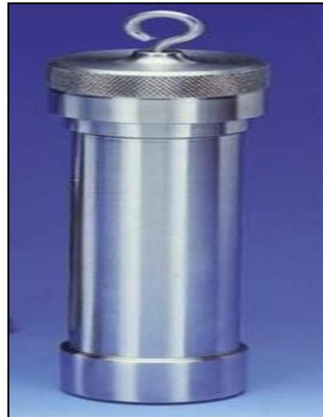
**Figure III.9 :** Bombe pour mesurer la corrosion.
