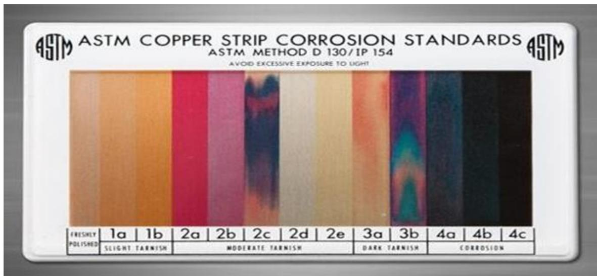
**Figure III.10 :** La série des lames de référence de la corrosion.
