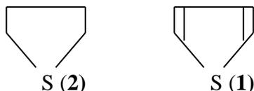
Les composés sulfurés sont indésirables, par ce qu'ils diminuent le nombre d'octane de l'essence, en agissant sur l'efficacité de l'action des additifs antidétonants, tels que le P.T.E (Plomb-tétraéthyle).
