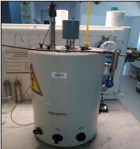
**Figure III.8 :** L'appareil de mesure de la corrosion à la lame de cuivre.
