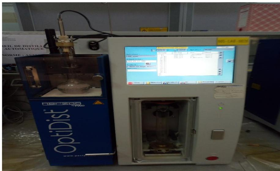
Figure III.6 : appareille de distillation A.S.T.M.
