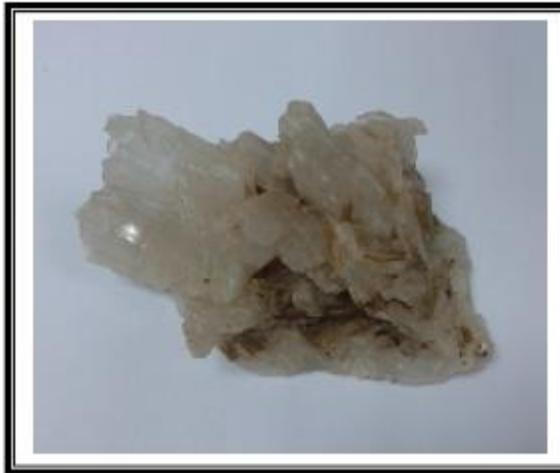
**Figure n°18** : Photo d'un dépôt de  $\text{CaSO}_4$  [14].
