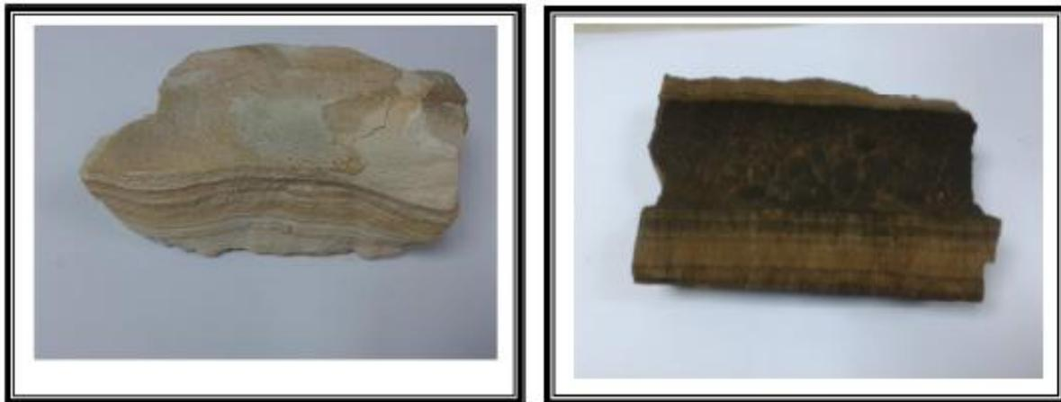
Figure n°17 : Photos des dépôts de sulfates de baryum[14].
