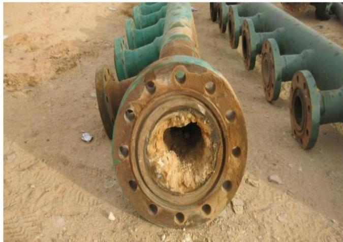
**Figure n°15** : Photographie d'un pipeline bouché par le dépôt [37].
