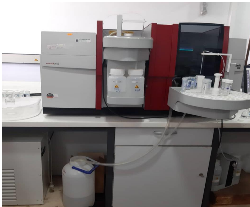
Figure III- 11: Dispositif expérimental de spectrométrie d'absorption atomique.
