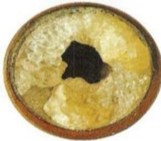
Figure I- 2 : Dépôt des chlorures de sodium (NaCl)
