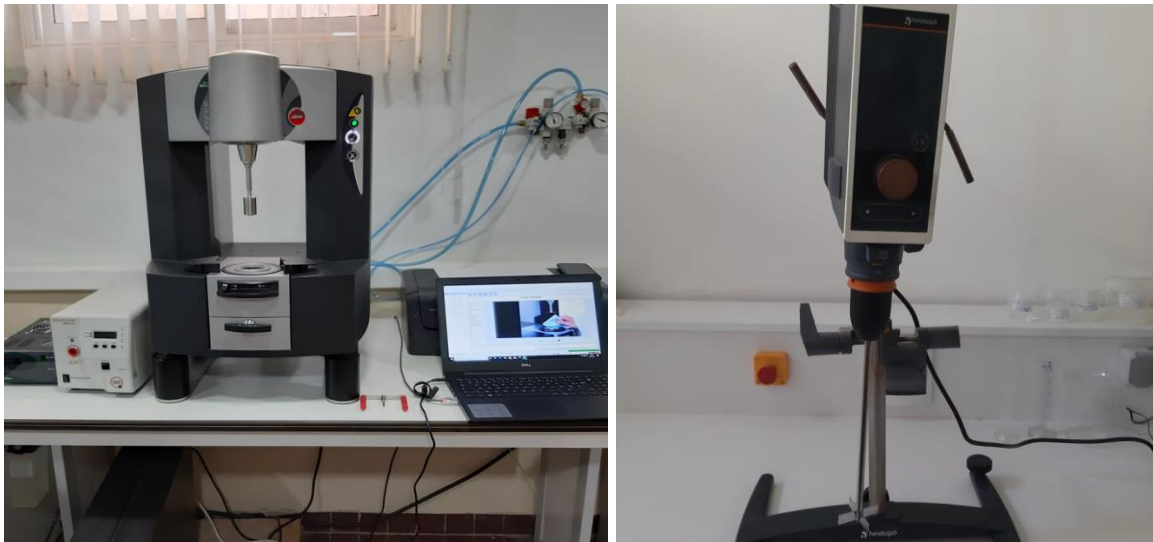
Figure IV- 9: À gauche le rhéomètre de Malvern Bohlin (Kinexus ultra plus) utilisé pour les mesures de viscosité, À droite l'agitateur à palette ou à hélice (Heidolph, model RZR2041)
