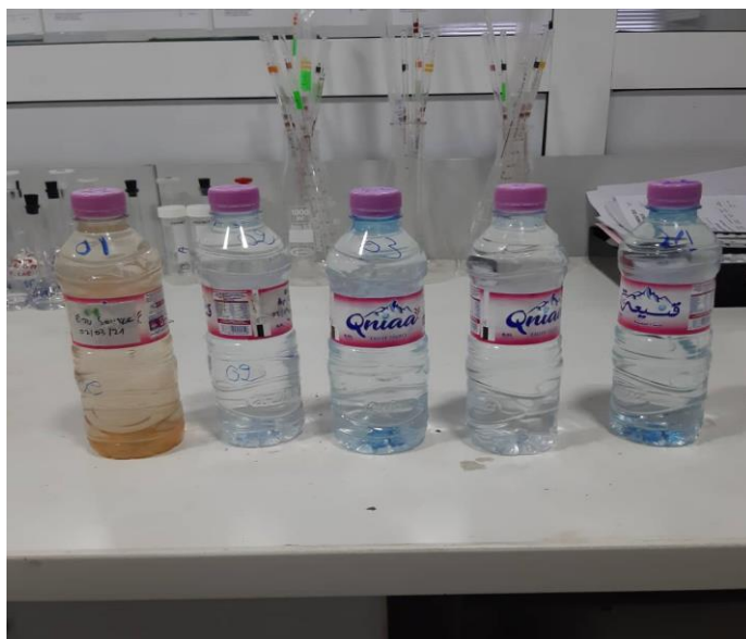
Figure III- 3: Image représentant : 1/ eau de source (LIAS), 2/ eau de source préfiltrée avec le sable et le charbon actif, 3/ eau concentrée issue de 2RO, 4/ eau de perméat issue de 2RO, 21/ eau de perméat issue de la NF.
