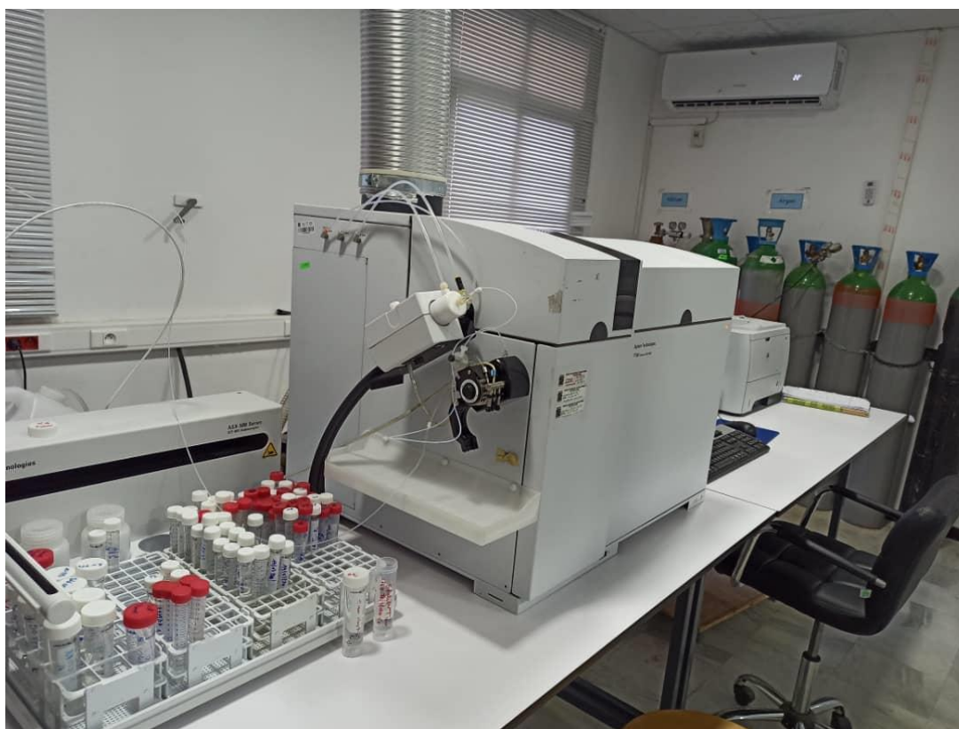
Figure III- 13: Représentation du couplage Torche à Plasma - Spectrométrie de masse.
