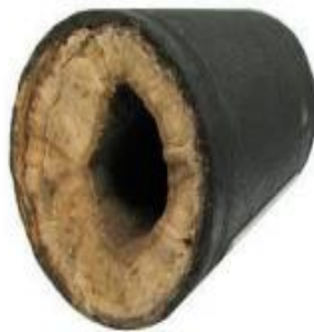
Figure I- 5 : Dépôt des sulfates de calcium ( \text{CaSO}_4 )
