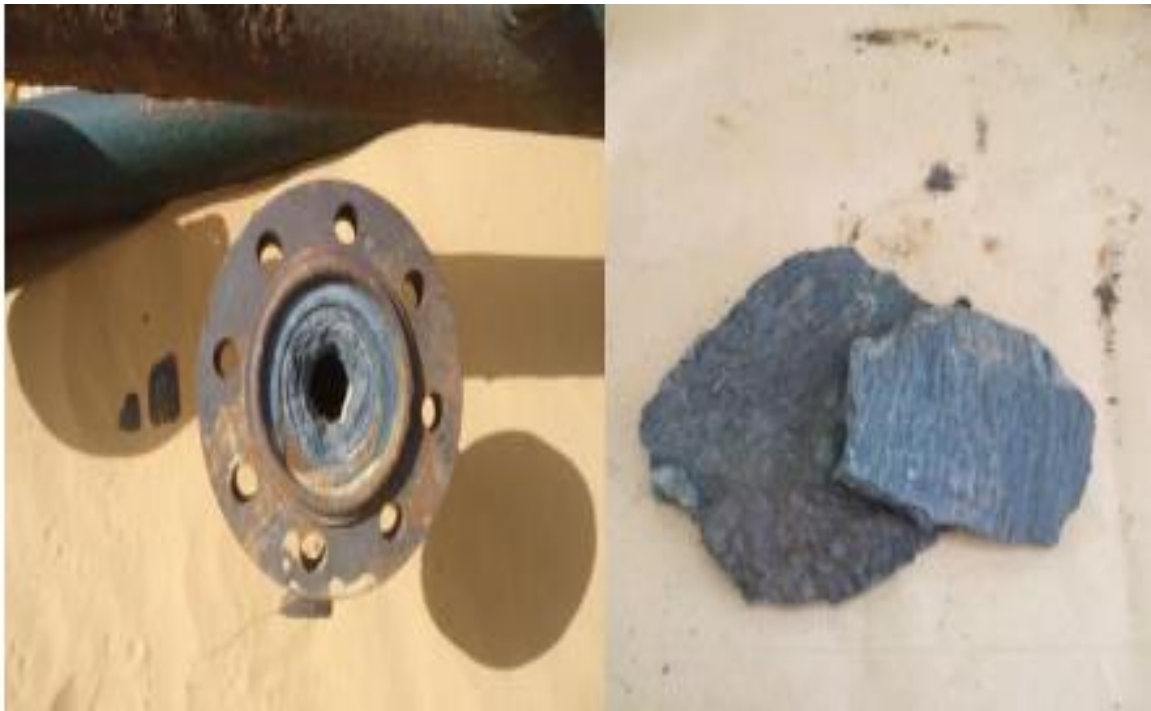
Figure I- 3 : Dépôt des sulfates de baryum ( \text{BaSO}_4 )
