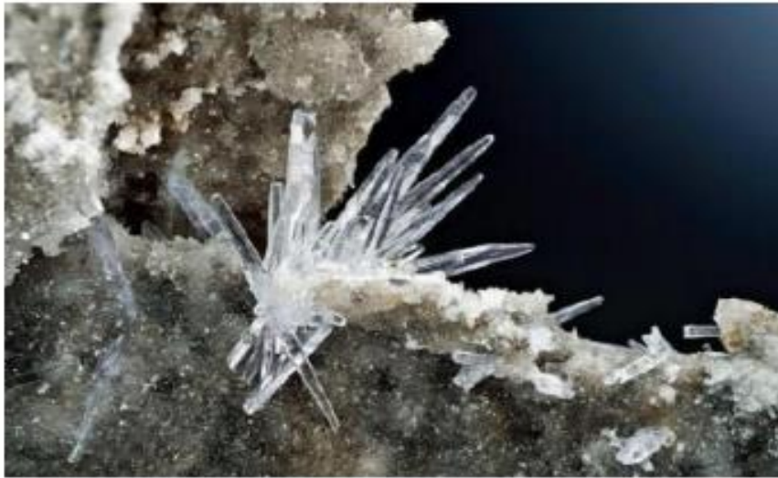
Figure I- 4 : Dépôt des sulfates de strontium ( \text{SrSO}_4 )
